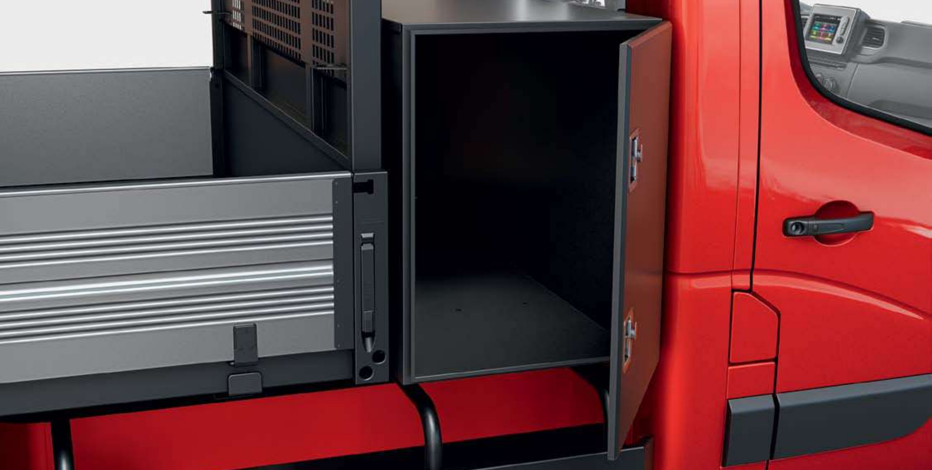
coffre à hauteur de cabine, jusqu'à 1,3 m³
