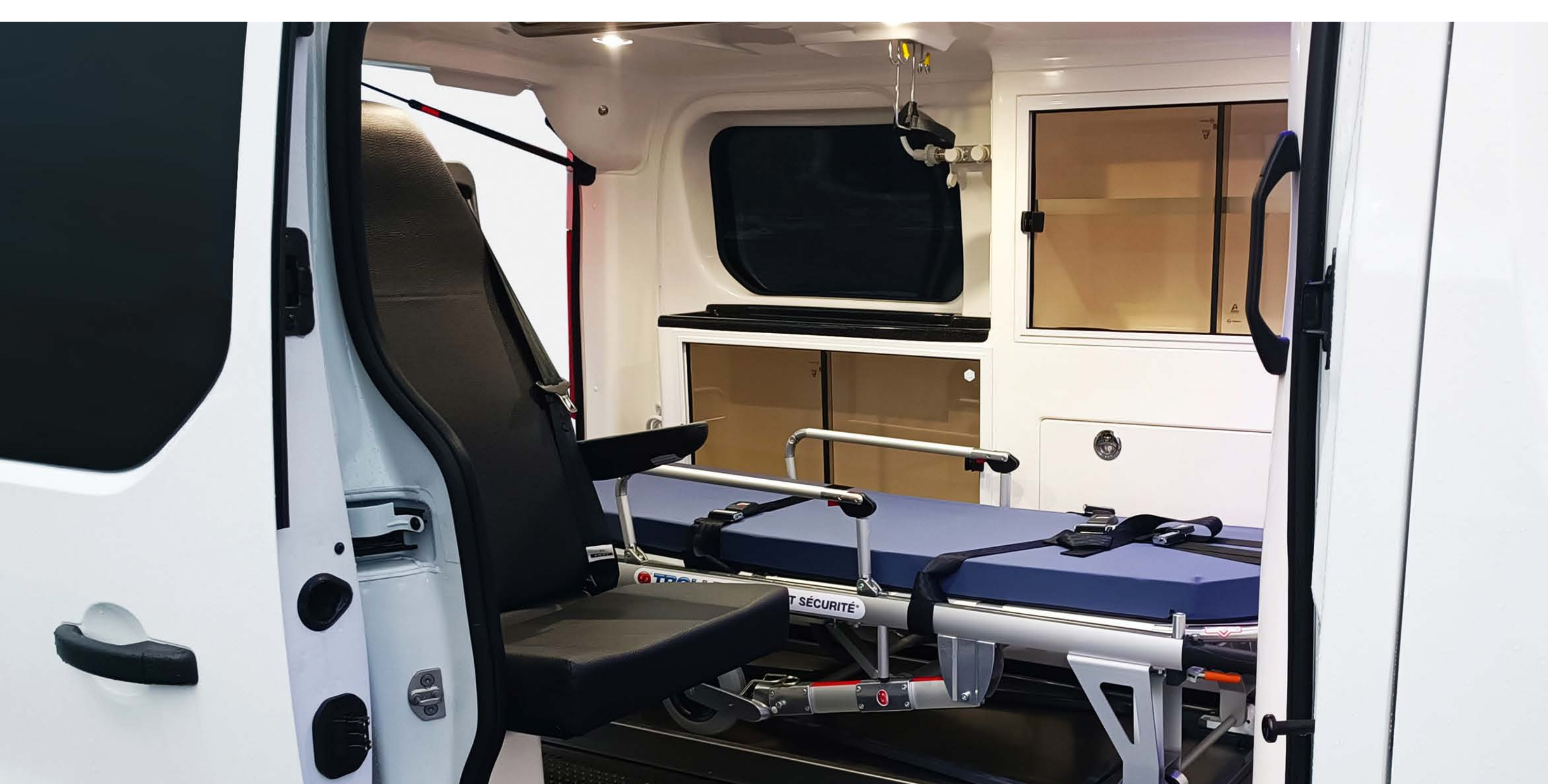
plusieurs configurations de cellule sanitaire possibles : siège accompagnant avec dossier réglable
