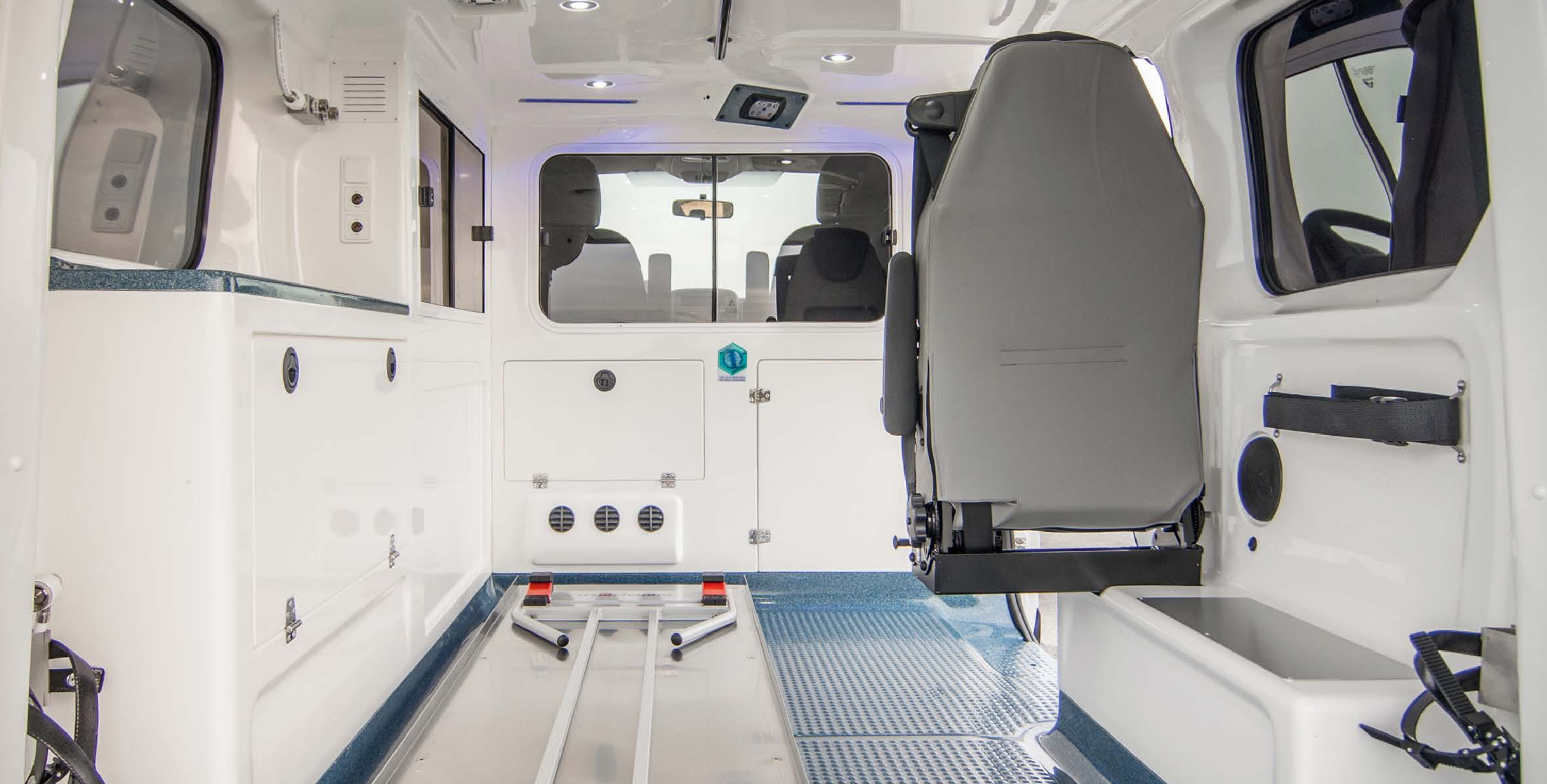
plancher isolé avec revêtement antidérapant, guides brancard et grands espaces de rangement fermés
