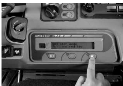
1 Insérez la clé Rouge d'enregistrement, puis pressez le bouton sur le tableau de bord.
